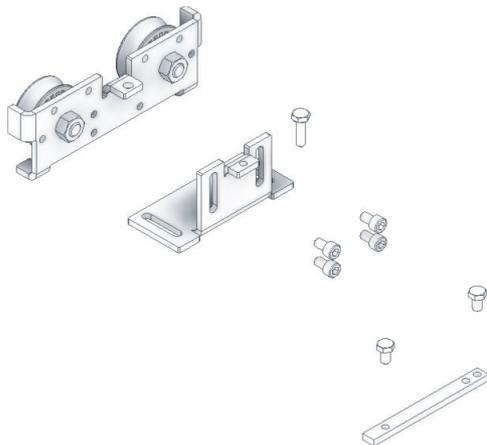
(Figura 2) Encaixe o suporte de fixação do vidro no pega vidro
