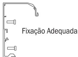
Para melhor fixação do trilho (perfil) do equipamento, devemos retirar o trilho externo fixo ao trilho principal, para fazer isso devemos retirar a correia externa, que esta acoplada ao motorreductor e marcar sua exata posição, caso haja a necessidade de retirar mais algum componente do automatizador para a fixação do trilho deve se marcar também o local exato onde ele está fixado.
