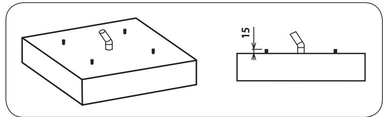
5. Posicionar o gabinete sobre a base, encaixando os furos do gabinete nos parabolts
