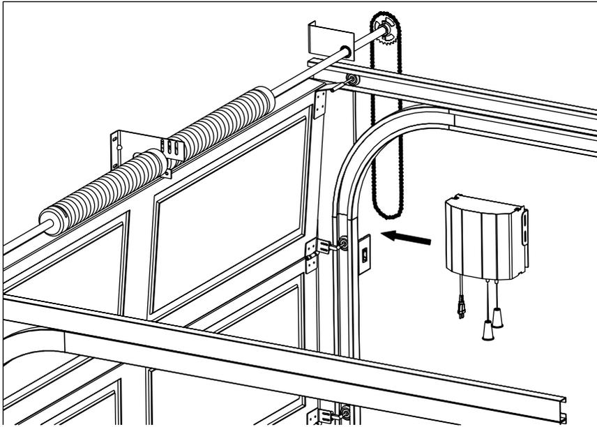
4º Passo - Para ajustar o alinhamento entre as coroas, é preciso deixar a máquina no manual e movimentar a folha da porta de modo que a Coroa Tracionadora seja alinhada com a coroa de saída da Máquina.
