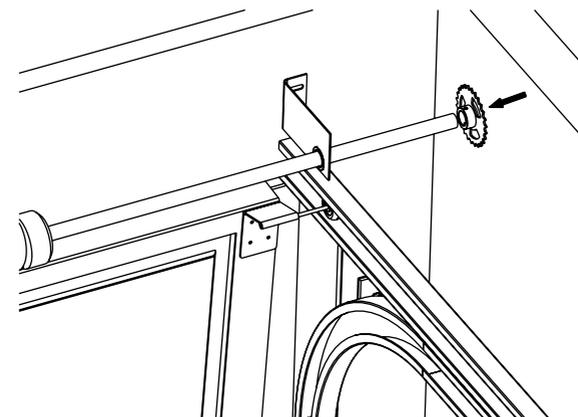
2º Passo - Coloque os parafuso Allen e a corrente sobre a Coroa Tracionadora e deixe-a pendurada.
