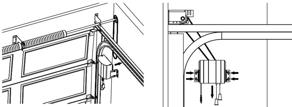
4º Passo - Para ajustar o alinhamento entre as coroas, é preciso medir a distância da parede até a face da Coroa Tracionadora (Distancia X). Afrouxe as porcas dos parafusos Francês das cantoneiras e ajuste a distância entre a parede e a máquina igual a (Distancia X + 20mm), após o ajuste, volte a apertar as porcas do Parafusos Francês das cantoneiras para travar a máquina na medida regulada.
