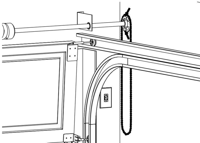
3º Passo - Posicione a máquina na parede e engate a outra extremidade da corrente na coroa da máquina e marque, fure e parafuse a máquina na parede. Ajuste a tensão da corrente para deixar esticada.
