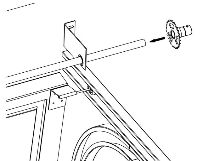
2º Passo - Coloque a corrente sobre a Coroa Tracionadora e deixa pendurada.
