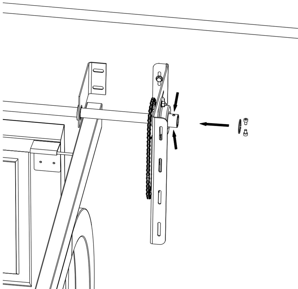
7º Passo - Posicione o Automatizador na Chapa Mancalizada e encaixe a corrente na catraca, coloque os parafusos de fixação da máquina.
