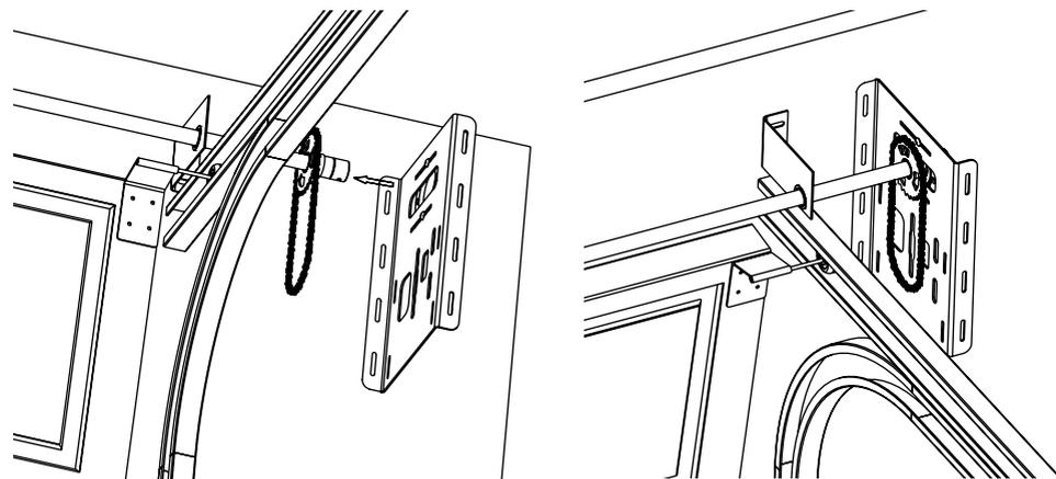
4º Passo - Solte os parafusos do mancal e encoste a chapa na parede. Torne a apertar os parafusos do mancal do rolamento.
