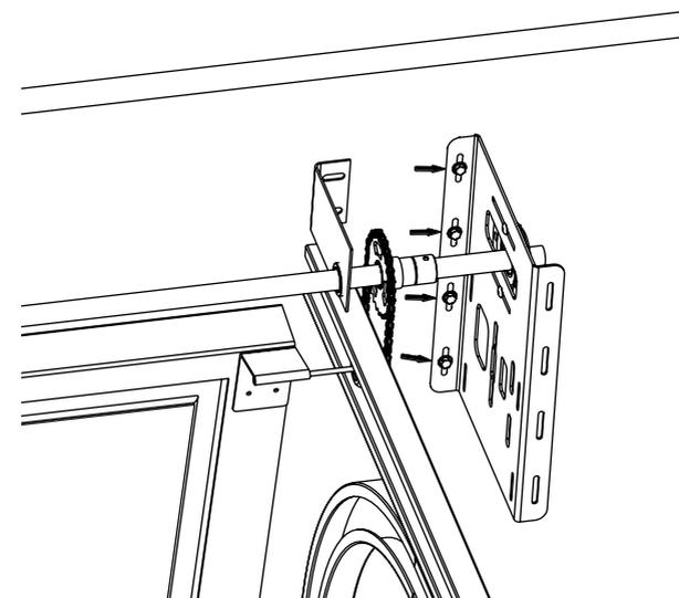
6º Passo - Torne a encaixar a Coroa Tracionadora junto a chapa mancalizada, trave a coroa com o anel elástico e aperte os dois parafuso para travamento do Eixo da Porta Sesscional Ø 25mm.
