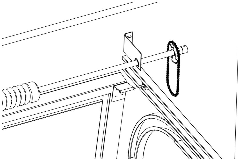
3º Passo - Posicione a Chapa Mancalizada junto a Coroa Tracionadora, e encaixe na posição de montagem.
