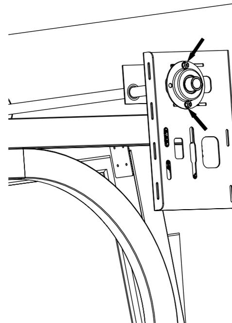
5º Passo - Afaste a Coroa Tracionadora do mancal, use a chapa mancalizada para marcar os 4 furos na parede e fure na marcação. Fixe com os parafusos do Kit.
