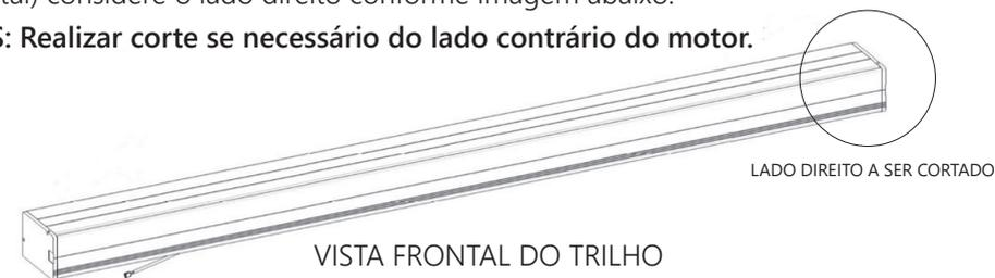
**1º Passo:** Para realizar a fixação do trilho na estrutura de alvenaria é preciso fazer os furos com diâmetro do parafuso usado espaçados entre >500<800 utilizando os guias externos. Logo abaixo tem o exemplo de instalação na parede; para instalação no teto utilizar os guias externos superiores.
