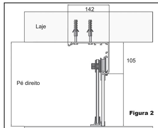
**3º Passo:** Da instalação do automatizador Tore em um vão de corredor: na instalação dentro do vão e necessário que a estrutura suporte o peso do automatizador e também os vidros, caso perceba que não irá suportar peça para reforçar a estrutura.
