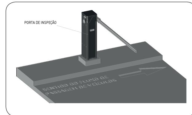
2. Posicionar / alinhar o gabinete sobre a base e fazer a marcação dos furos, de modo que a frente da cancela (lado da porta de inspeção) esteja localizado em direção ao meio fio (rua, passagem de veículos)
